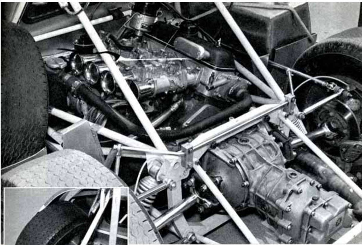
エンジンはコンテッサ・クーペの4気筒、71mm×79mm、1251cc、圧縮比9.0:1にスポーツ・キットをつけて、110ps以上にチューン・アップしたもの。変速機は「ヒューランドMK 4」の4速。スベア・タイヤは左側のスペースに付まれる。
