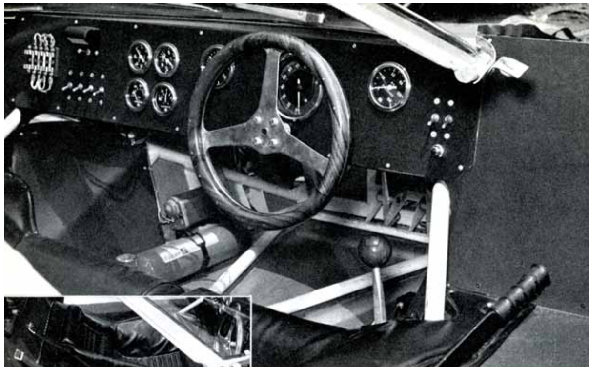
機能的で美しいコックピット。一番右のレバーがエアフォイルの角度を変えるもの。その内側がシフト・レバー。シートは固定式でペダルで調節する。メーターは中央がエンジン回転計（7000rpmまで）その左に燃料圧、油温、ミッション油温、電流計、冷却水温計、一番右に油圧計が並ぶ。
